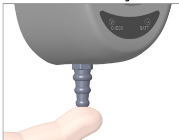
Figure 6 : Bloquez l'orifice inférieur avec le doigt
