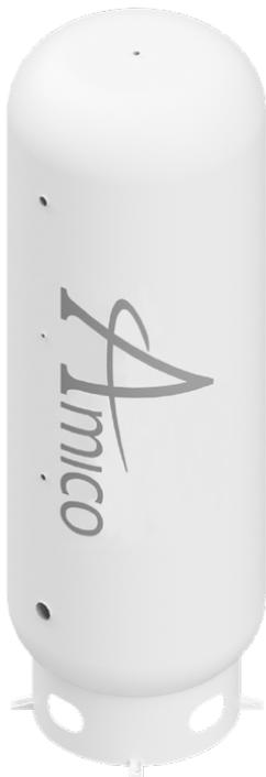
El receptor de aire se utiliza como un medio de almacenamiento y Sistema de control para garantizar un flujo de aire constante. Además, el tanque receptor de aire elimina las pulsaciones de la línea de descarga, reduce los costos de energía asociados con arranques excesivos del motor y contribuye a la separación de humedad, aceite y partículas del aire.
